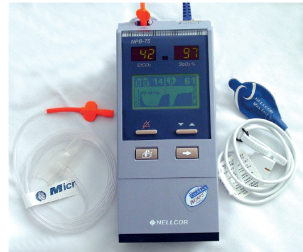
FIGURA 41-3 Strumento portatile per capnografia e pulsossimetria con visualizzazione dei relativi tracciati: la soluzione ottimale per l'emergenza extraospedaliera.
